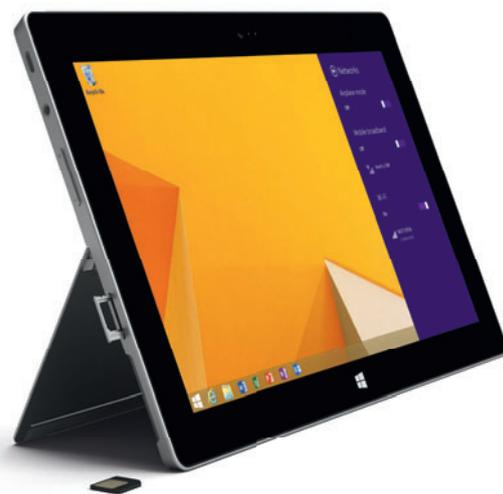
ется на четырехъядерном процессоре nVidia Tegra 4. Он оснащен 10,6-дюймовым экраном с разрешением 1920×1080 точек, камерами на 3,5 и 5 Мпикс, 2 Гбайт ОЗУ, microSD-слотом и пр.
