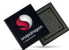
Все восемь ядер в новой SoC могут работать одновременно, но вот частоту разрешается регулировать только в рамках кластеров по четыре штуки (для сравнения: в процессорах Krait частота может быть разной для каждого ядра).
